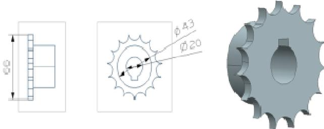
Fig. 4. Smaller Sprocket
